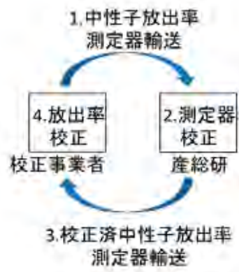
図2 中性子放出率測定器による校正
