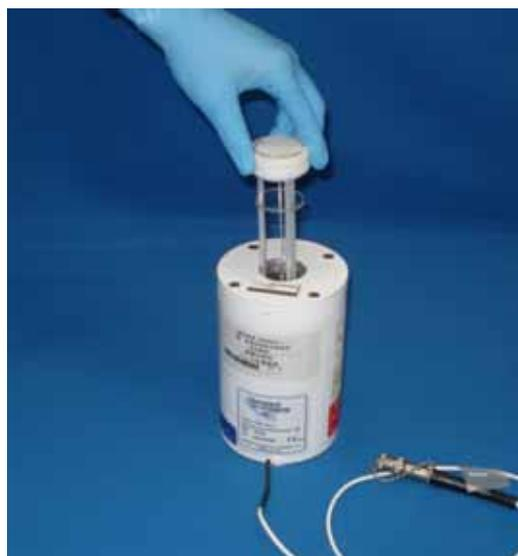
図 4 特定二次標準器となる井戸型電離箱線量計
