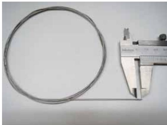
図 1 RALS で用いられている線源と同じ形状のダミー線源
