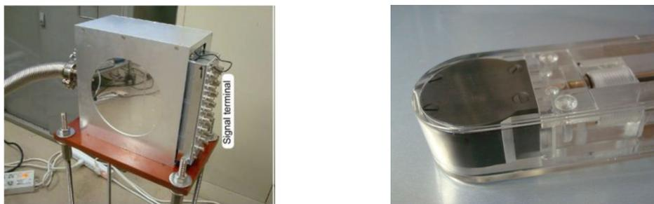
図1 グラファイトカロリメータ（左）及びグラファイト壁空洞電離箱式照射線量設定装置（右）
