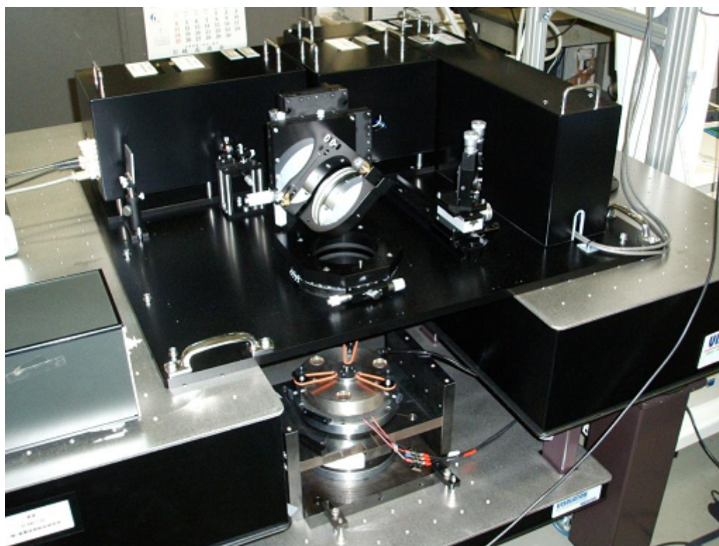
図5 特定標準器(高周波測定装置：5 kHz～10 kHz)
