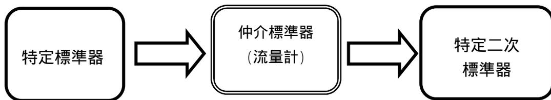
図 2 仲介標準器を使用した特定二次標準器の校正
