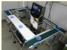
評価技術例：周回コンベヤによる無人連続計量
