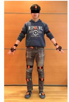
慣性センサを用いた身体運動計測による現場環境での計測
