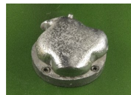
圧搾後の試料外観（ADC12合金）
