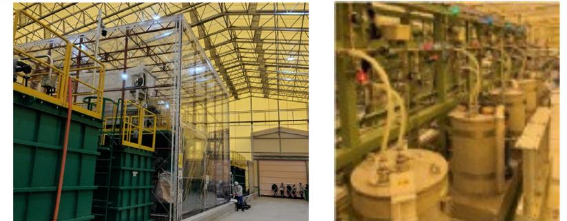
実機サイズのパイロット試験設備：灰洗浄設備の一部（左）とセシウム吸着カラム（右）
