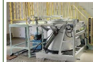
容量100kgの溶解炉
