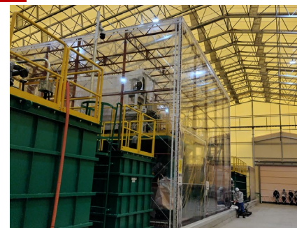
実機サイズのパイロット試験設備：灰洗浄設備の一部（左）とセシウム吸着カラム（右）
