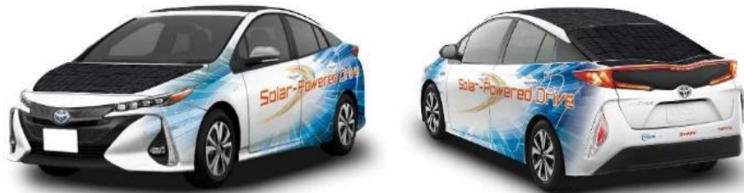
太陽電池パネルを搭載したNEDO事業で作製した走行実証車
