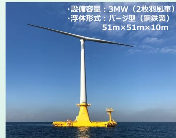
■ 浮体式洋上風力発電システム実証機「ひびき」
