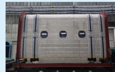
長さ5m (気密疲労試験)
