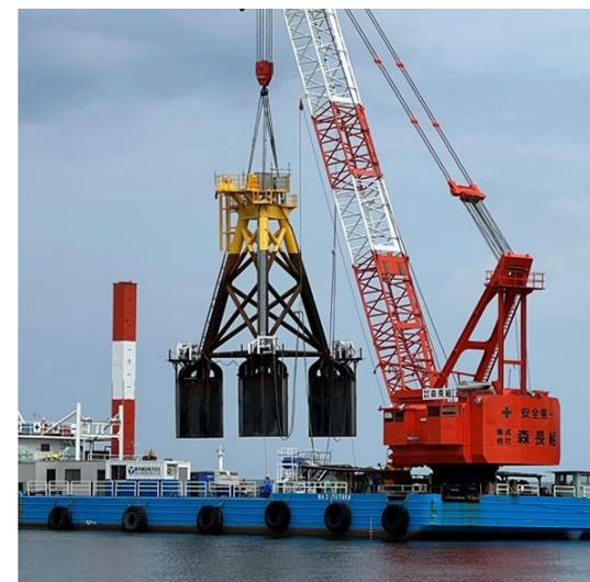
■ マルチバケットの試験体
