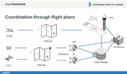
共有空域では、飛行計画の調整をドローン-従来のVFR機-「空飛ぶクルマ」で行い接近回避 (ICAO Drone EnableにてPolastre氏)<sup>7</sup>
