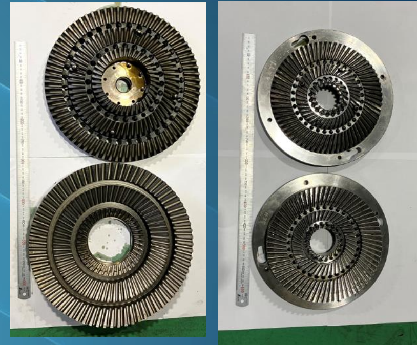
ばね鋼圧延材プレス品の熱処理焼入 と同時に成型に使用
