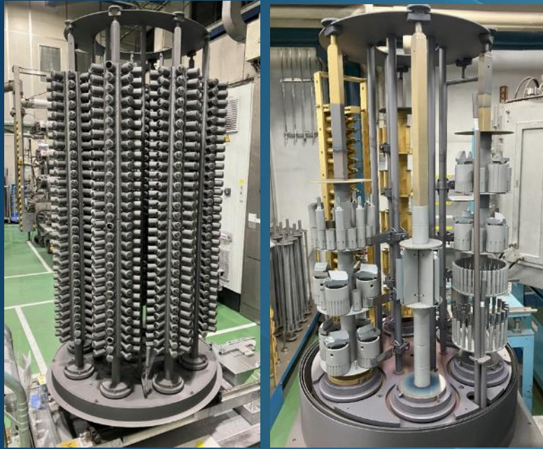
各種コーティング処理時、 製品セットするためのもの
