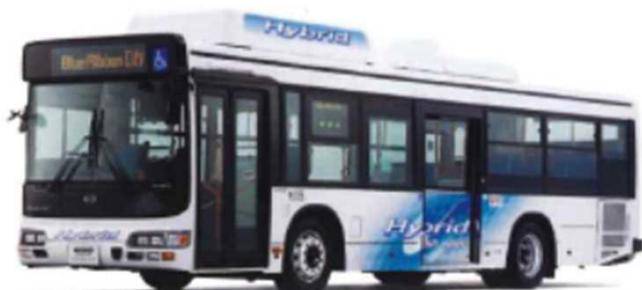
電気によるモーターとディーゼルエンジンを併用して走行
