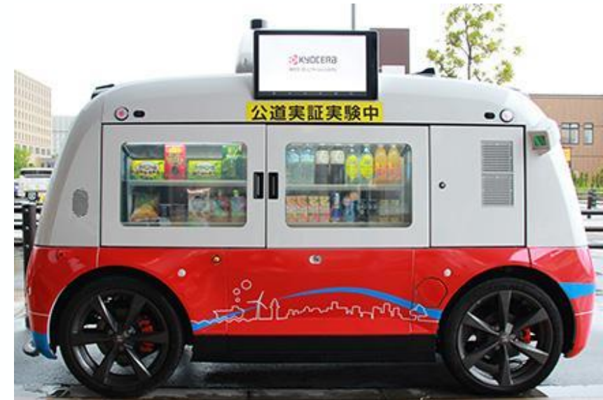
移動販売用途として荷室が設計された 中速・中型ロボット
