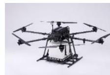
PD6B-Type3 プロドローン（日） 20kg, 25分(5kg)
