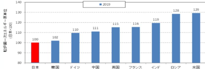
電炉鋼のエネルギー原単位 推定結果 (2019年、日本=100)
