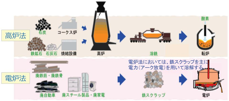
電気炉製鋼は従来から徹底した省エネルギーを実践しており、 製造時に使用するエネルギーのうち60%から80%が電気エネルギーで、すでに電化を実現しているプロセスです。 よって、カーボンニュートラルな電炉鋼とするためには電力エネルギーの非化石化が必要となる。
