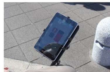
車いす側に取り付けたタブレットに 信号の灯色情報を表示
