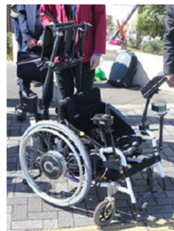
車いす側に取り付けたタブレットに 信号の灯色情報を表示
