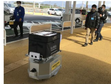
実証実験で人が監視しながら農産物のロボット集荷が行われる様子。(筑西市)
