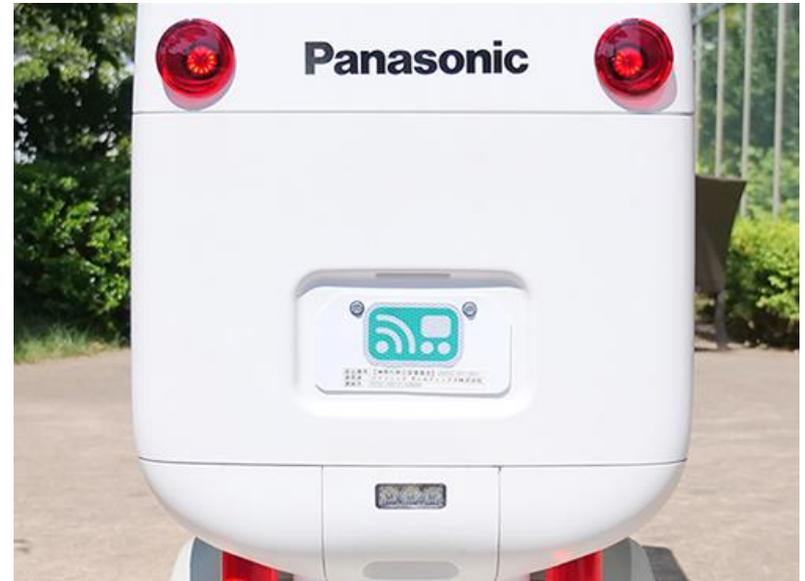
遠隔操作型小型車標識の掲示
