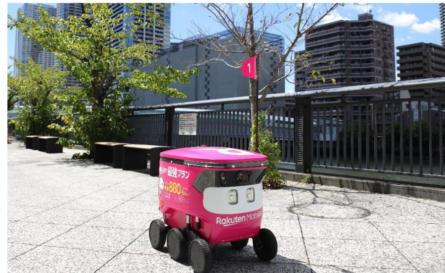
視認性確保のため旗を備える遠隔操作型小型車 (機体本体の高さ：61.8cm 旗を含めた場合の高さ：120cm)
