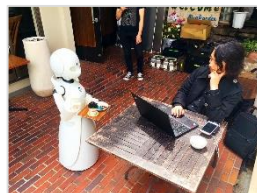
外出困難な人のテレワークを可能にするロボット OriHime-D オリ研究所
