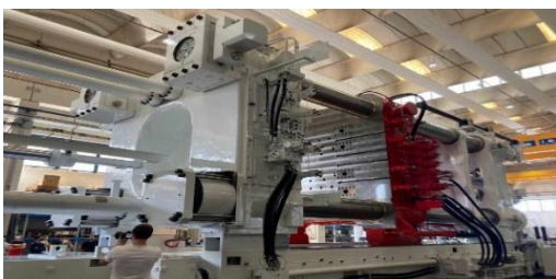
出所：米テスラ社HP IDRA社 9000トンダイカストマシン「ギガプレス」
