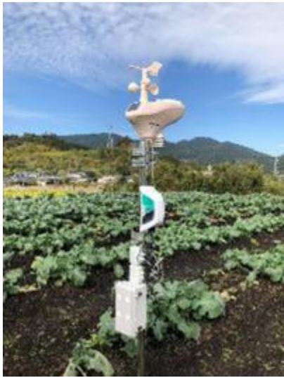
農業用IoTセンサー (フィールドサーバー)
