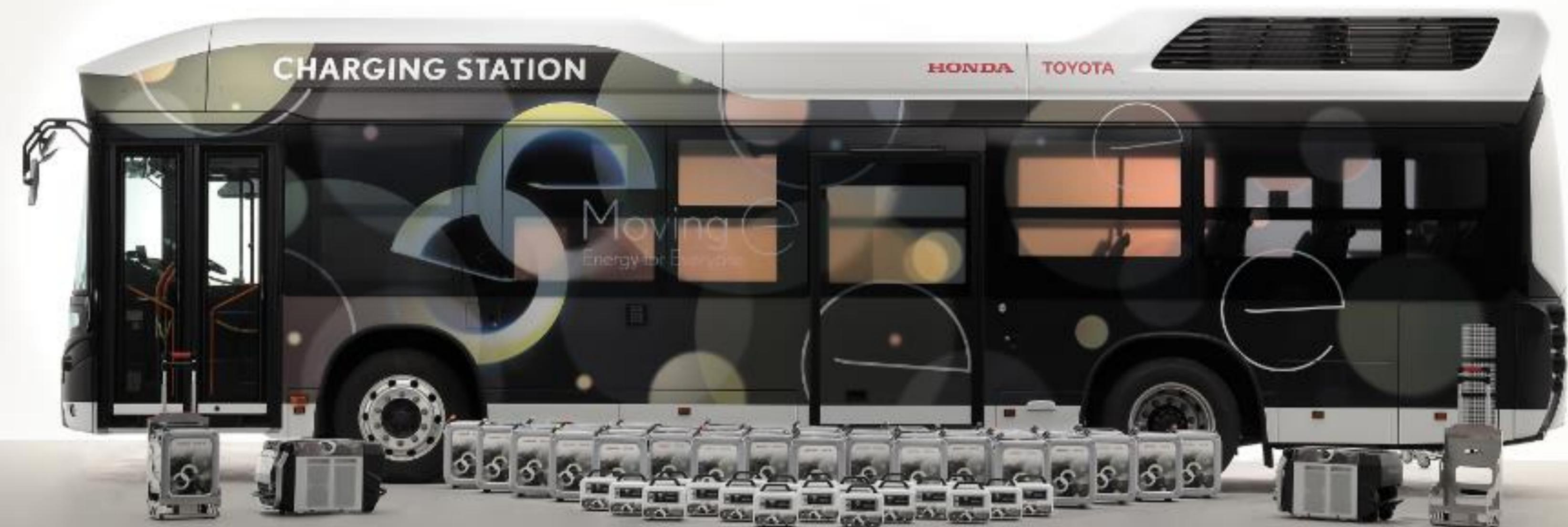
トヨタホーム『クルマ de 給電』 電動車のアクセサリコンセントから直接住宅へ電力供給
