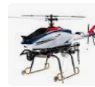
FAZER R G2/ ヤマハ発動機 動力：ガソリン MTOW：110kg
