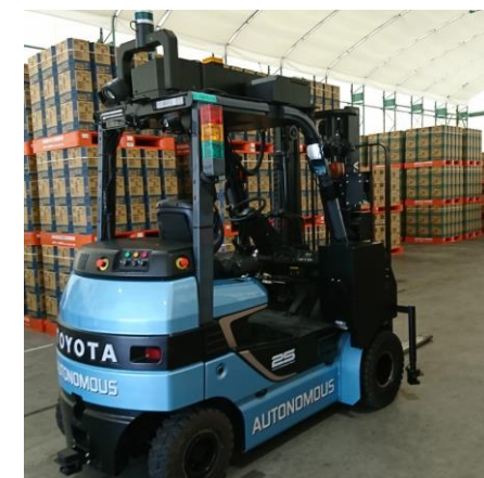
自動運転フォークリフトでの積み込み 2023年1月 花王坂出LCで実証実験
