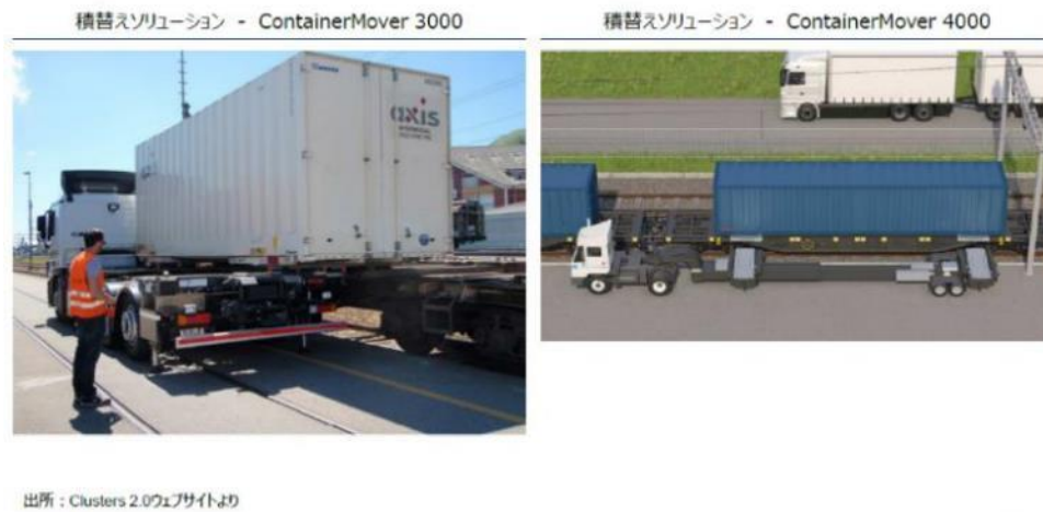
図 2-14 鉄道・トラックの積替技術検証
