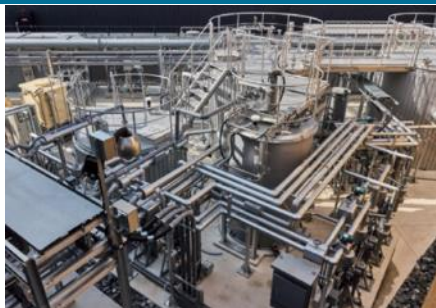
会場内の生ごみから水や電気を生み出したバイオガスプラント
