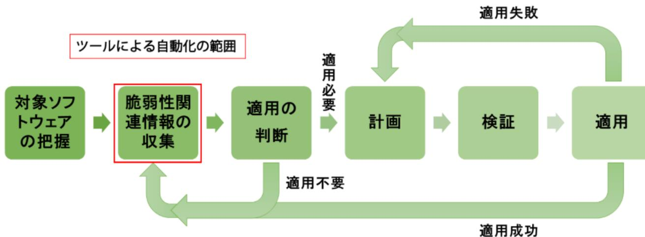
図 3-13 脆弱性対策のフロー（例）<sup>44</sup>
