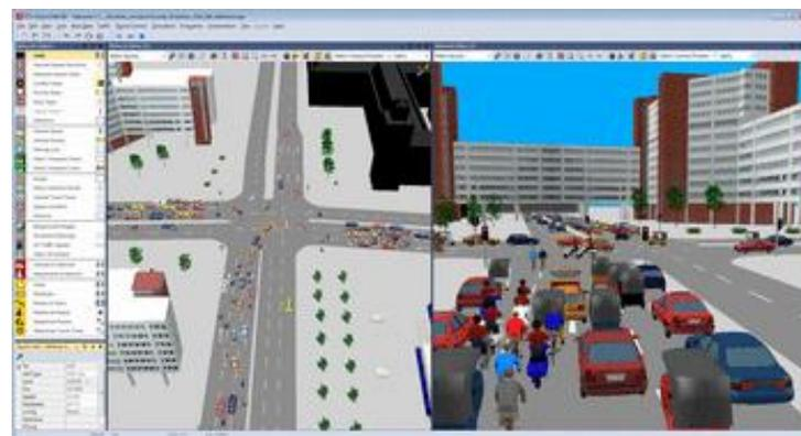
混合交通のシミュレーション：様々なタイプの車両（自動車、二輪車、自転車）共有と車線無視。
