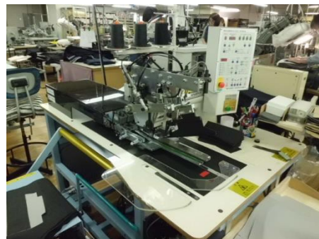
※ 3機導入したうちの1機のポケットシーマー (ポケットの縫製自動機(マシン))
