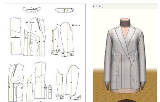
3DCADによる工業用パターン作成
