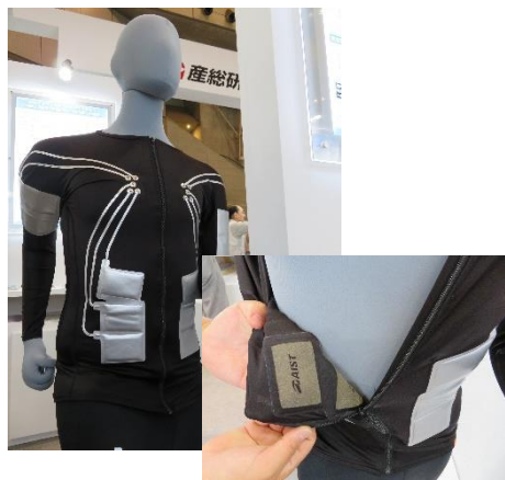
起毛電極をもちいたアクティブ筋電ウェア
