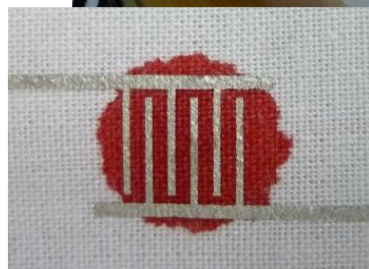
布上に印刷形成された漏血センサ
