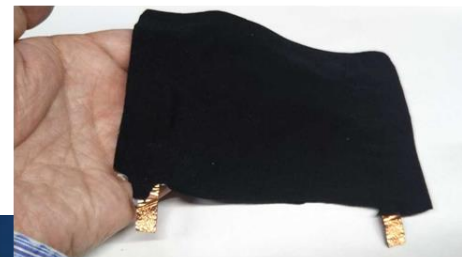
導電織布による圧力分布センサーと、それを用いた バランスボース・トレーニング・システム
