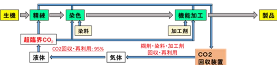
（図2）革新技术：無水型超臨界染色加工
