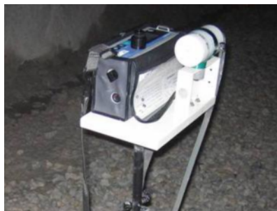
写真 1 質量濃度測定器と相対濃度測定器の併行測定時のセット例
