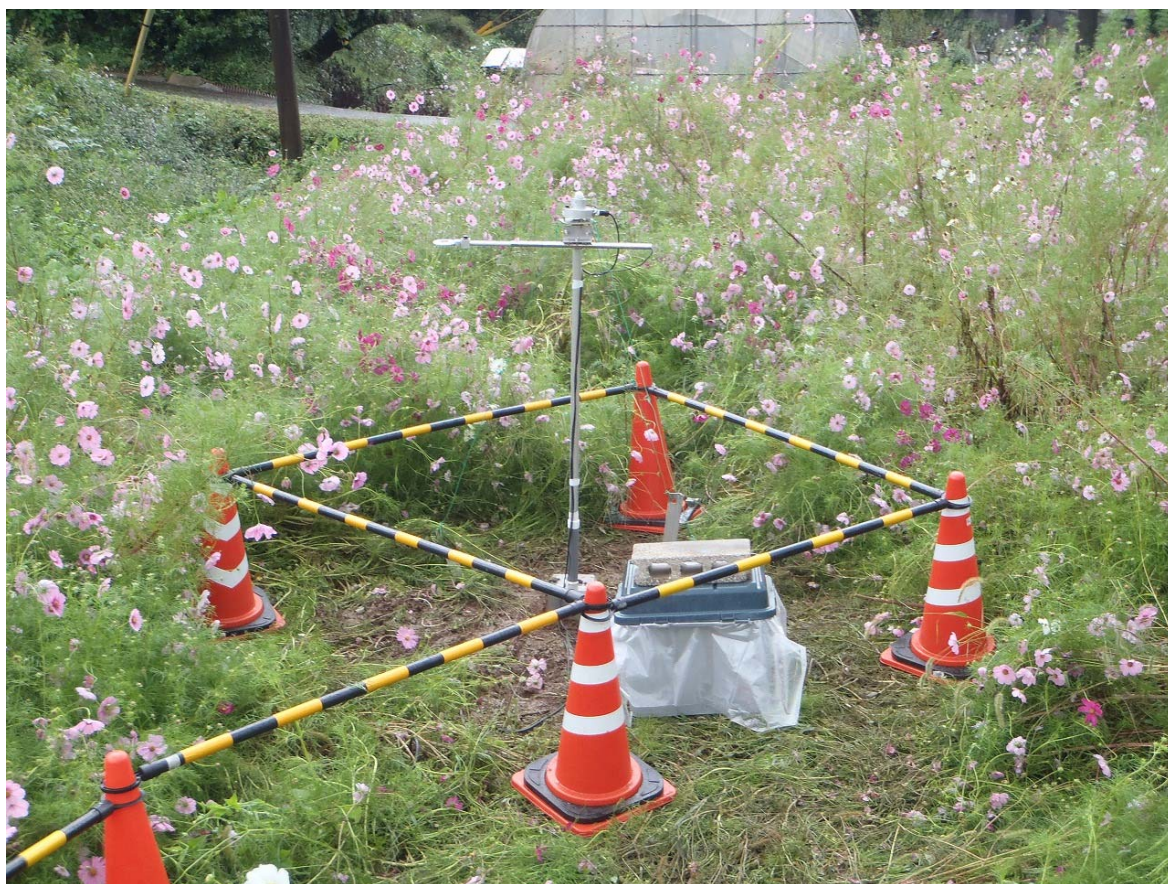
図 11(4) 調査状況（大気質、一般気象・大気質調査地点 A1（日射量及び放射収支量））
