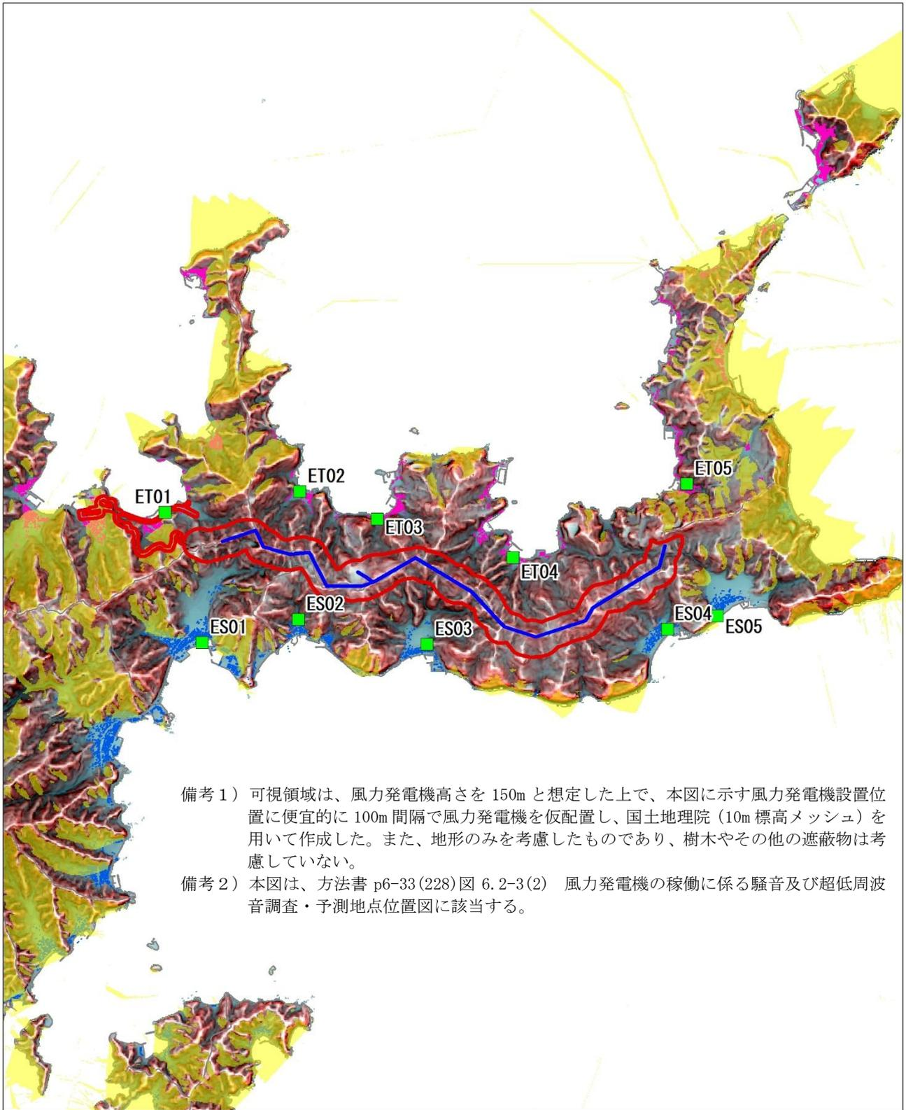
備考1) 可視領域は、風力発電機高さを150mと想定した上で、本図に示す風力発電機設置位置に便宜的に100m間隔で風力発電機を仮配置し、国土地理院(10m標高メッシュ)を用いて作成した。また、地形のみを考慮したものであり、樹木やその他の遮蔽物は考慮していない。
