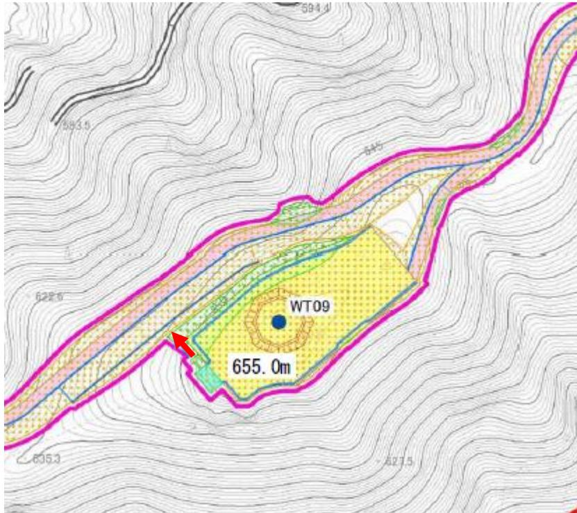
図 12-1 (1) WT09 ヤードにおける沈砂池排水の想定排水経路
