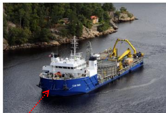
海底送電ケーブル敷設専用船
