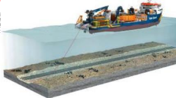
海底送電ケーブル敷設専用船
