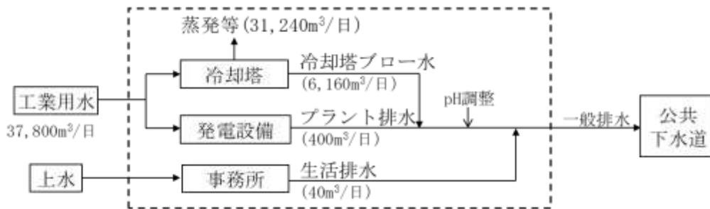
表 10-1. 冷却塔ブロー水の水質負荷内訳
