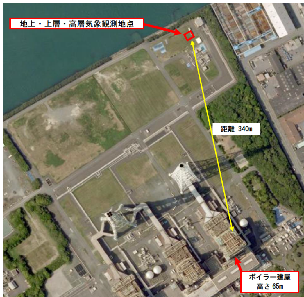
図 地上・上層・高層気象観測地点と周辺建屋の状況
