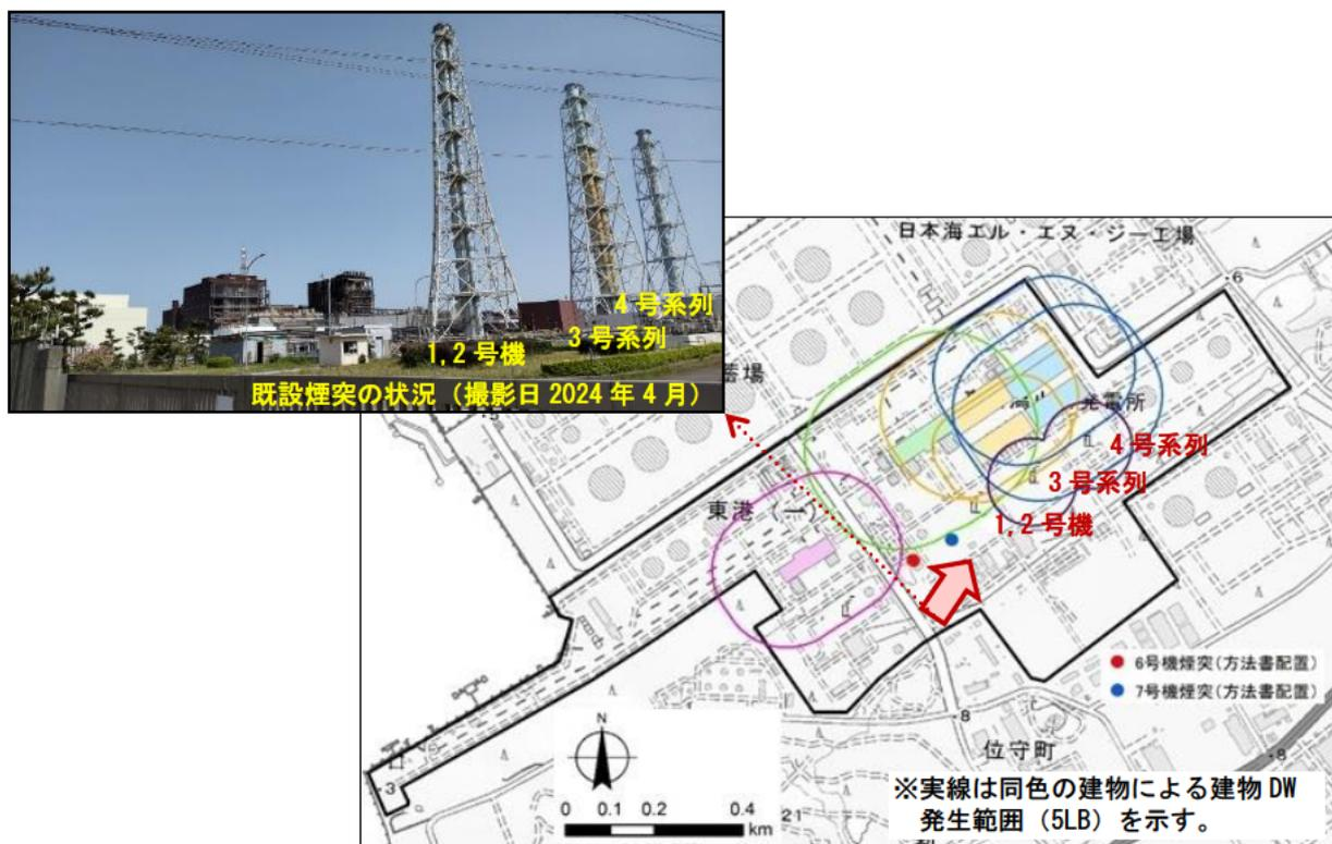
図17-1 新設設備の煙突位置と既設建物及び煙突の建物影響範囲
