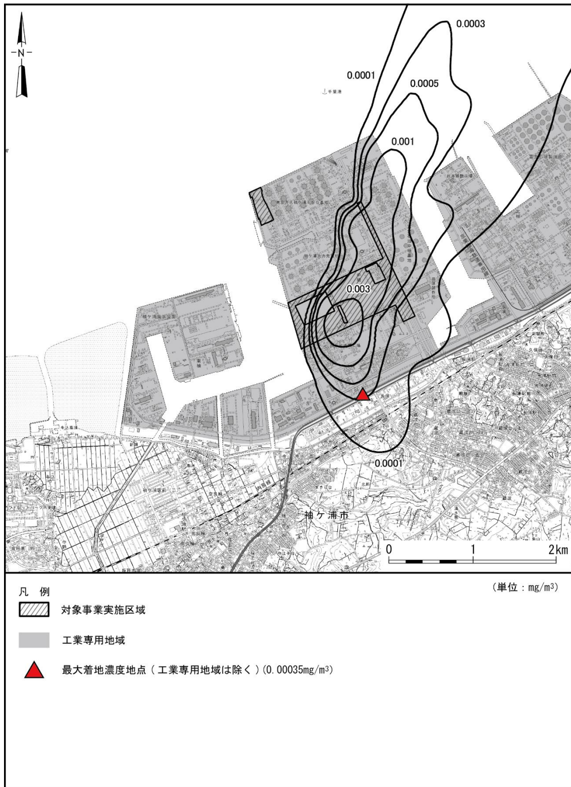
図 17-2 建設機械の稼働に伴う浮遊粒子状物質の日平均値予測結果
