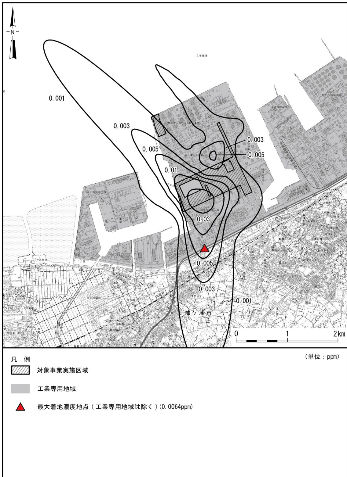
図17-1 建設機械の稼働に伴う二酸化窒素の日平均値予測結果
