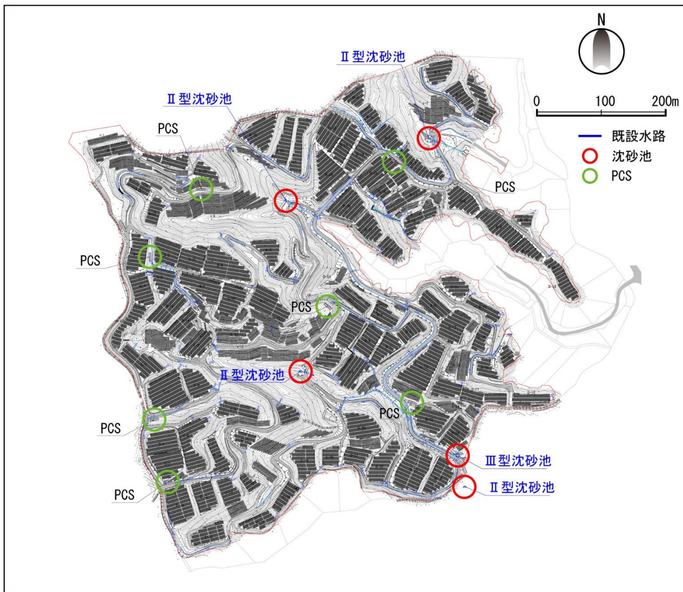
図 3-4 (5) 稲生野団地の沈砂池の種類と配置
