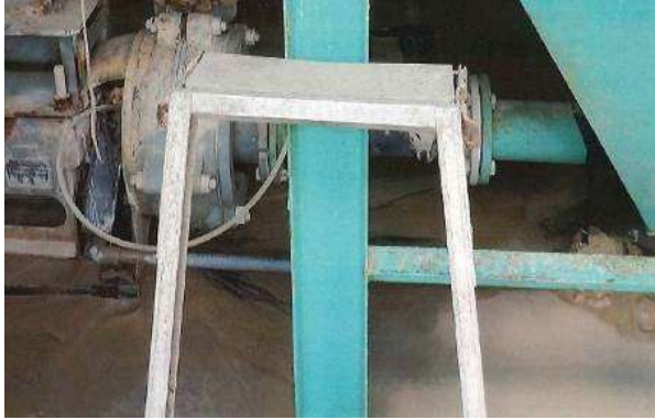
写真3 使用していたはしご (水洗タンクの脚に立てかけた状態)
